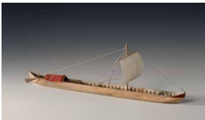
Évocation d'un bateau à fond plat d'après un texte de 1421. L : 30 m, l : 2,80 m. Capacité +/- 90 T. Conception M. Suttor, réalisation B. Clarys, Biface, 2008. Coll. MPMM. Photo M. Adam © SPW-AWaP
